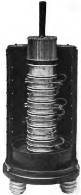
Figur 12. Sechsfach unterteilte Funkenstrecke.
